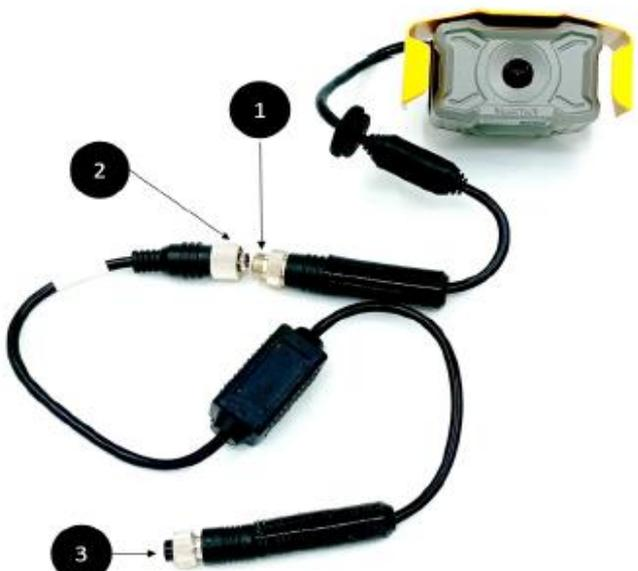
(1) Conector hembra de cámara 8P (Datos + Energía)
